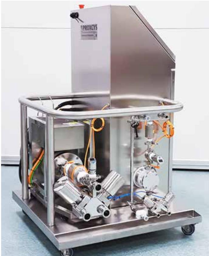
**PROXCYS HP-RFC** 撬装将系统的所有部件(包括Quattroflow™四柱塞隔膜泵)都搬到了移动车上, 操作十分便捷。在生物制品生产工艺中, 移动车经常需要移动, 这款轻量级解决方案能轻松实现这个目标。
