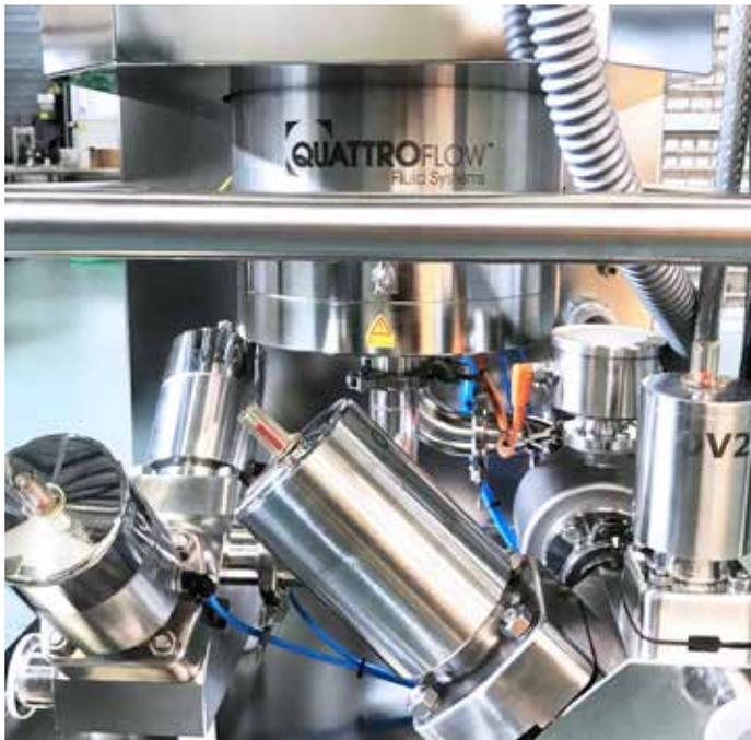
用树脂填充的HP-RFC柱能更好地分离目标蛋白。Quattroflow™四柱塞隔膜泵可以柔和地处理脆性/刚性树脂,能在树脂填充工艺中发挥重要作用。
