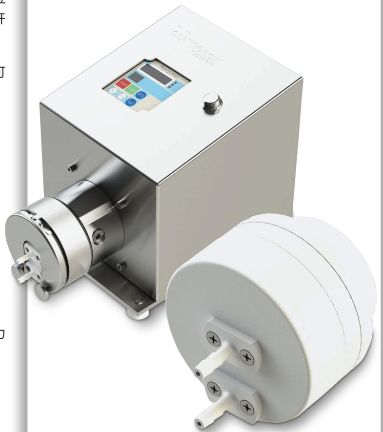
Quattroflow与客户密切合作, 研发生产用于制药及生物技术行业关键应用所需的特定隔膜泵。Quattroflow泵的运行方式能够温和、安全可靠地输送对剪切力敏感的水溶液和生物制品。该设计无需使用机械轴封或接液转动部件, 可确保产品整体密封良好, 无任何磨损。此外, 泵送原理可实现无风险干运转、低脉冲、自吸以及粒子最小化。
