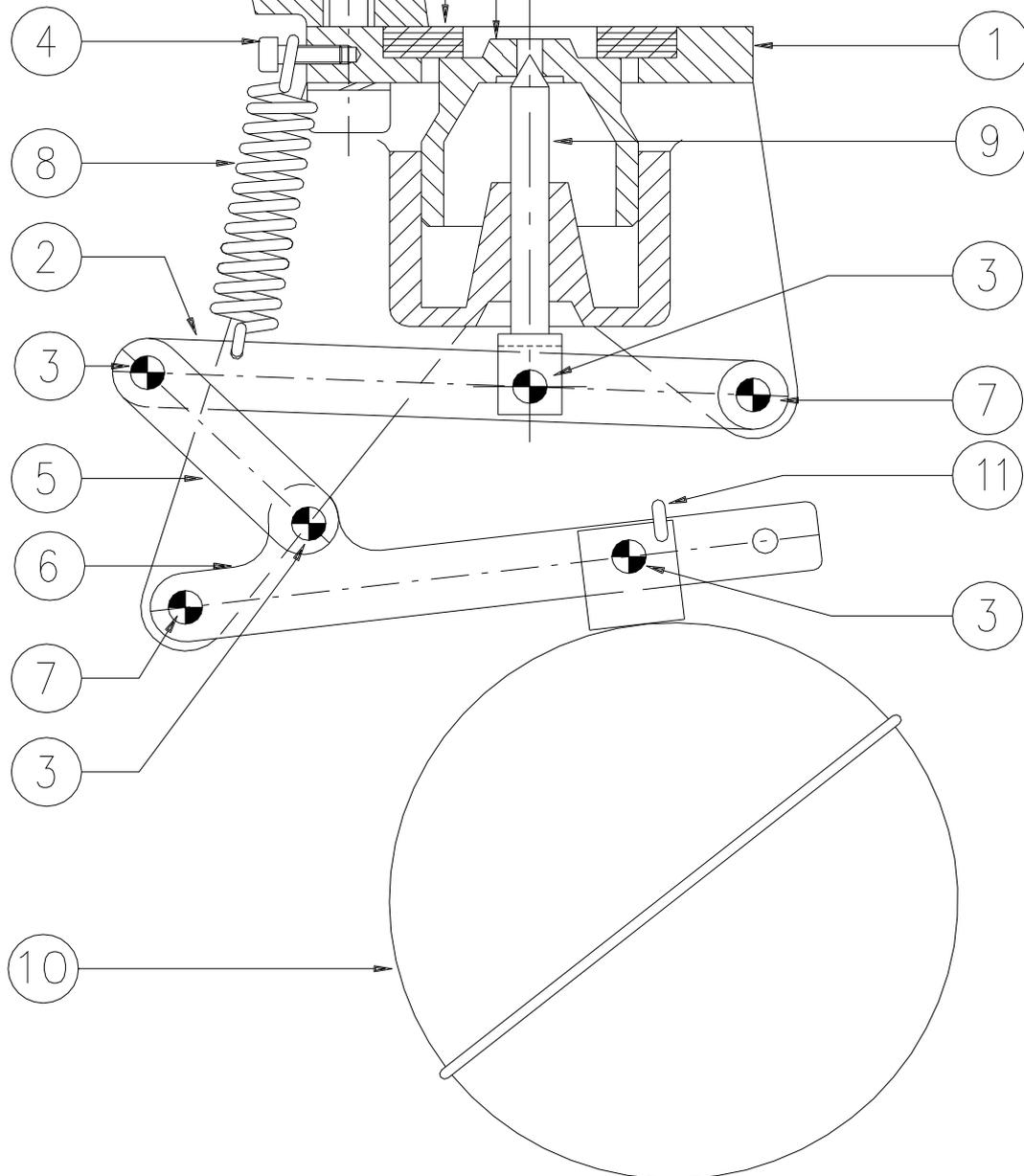
ASSIEME VALVOLA DEGASATRICE DIS. 565 GALLEGGIANTE Ø90 { COD. 80VA4021
