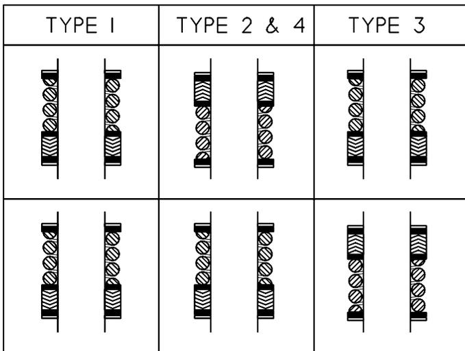
UPPER PACKING **SEAL ORIENTATION - DOUBLE SEAL COMPRESSORS**
