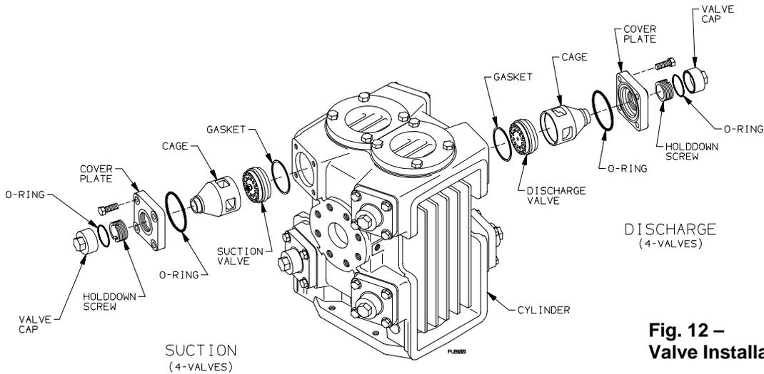
**Fig. 12 – Valve Installation**
