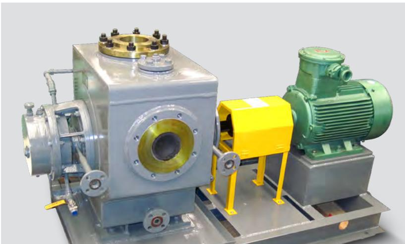
地面硫磺泵的技术源于双螺杆泵，作为经验丰富、技术领先、应用广泛的双螺杆泵制造商，百马LH系列是专为输送液体硫磺而设计的一种地面安装的螺杆泵。其产品性能特点如下：
