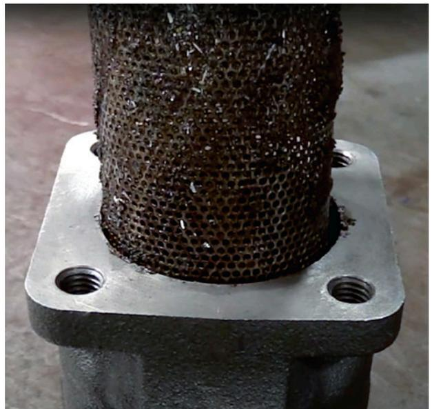
堵塞的过滤器预示对大多数流程泵带来常见问题的悬浮固体颗粒
