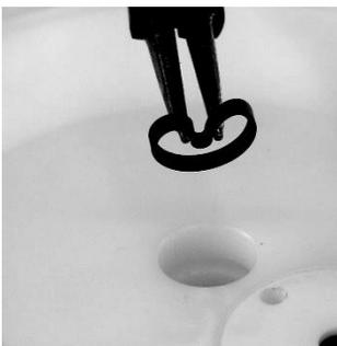
Zunächst die O-Ringe [20] einbringen. Es müssen neue Kolbenringe [20] verwendet werden. Zur Montage den Kolbenring [20] mit einer Sicherungsringzange vorsichtig nierenförmig biegen und in die Nut einsetzen. Danach die Aufwölbung des Kolbenrings [20] mit einem runden Gegenstand vollständig in die Nut drücken. Mit sauberem Zuganker [13] ausrollen. Schließlich die Kolbenstangenhülse, lang [39] einsetzen, und zwar an der Seite an dem sich der große Zylinderbuchsen-O-Ring [38] befindet.
