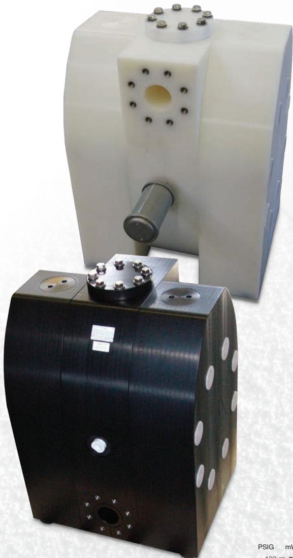
Die Baugröße E 80 erweitert die Angebotspalette der E-Serie auf sieben Baugrößen. Mit einer max. Förderleistung von 48 m³/h eignet sich die E 80 ideal zur wirtschaftlichen Umwälzung großer Mengen. Als Pumpenwerkstoff steht PE und PE-leitfähig zur Verfügung. Ein Ring für die gemeinsame Verpressung der Zuganker ist bei dieser Baugröße nicht vorhanden. Die Verwendung von Tellerfedern ermöglicht auch hier eine hohe Sicherheit und geringe Leckageanfälligkeit.
