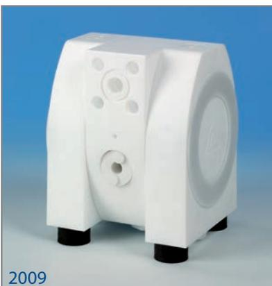
Die Gehäuseteile der E-Serie werden wie gewohnt über Zuganker miteinander verspannt. Allerdings stützt sich nicht mehr jeder Zuganker punktuell gegen das Gehäuse ab, sondern über einen Ring erfolgt auf jeder Seite eine gemeinsame Verpressung aller Zuganker. Ergebnis ist eine gleichmäßigere Verteilung der Vorspannkraft und ein höheres zulässiges Anzugsmoment – letztlich eine höhere Pumpensicherheit, die durch weitere konstruktive Verbesserungen noch unterstützt wird.
