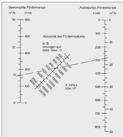
Die in den Pumpenkennlinien angegebenen Fördermengen sind generell auf Wasser (1 mPa·s) bezogen. Für Fördermedien mit höherer Viskosität ist eine entsprechende Reduzierung zu berücksichtigen. Das Diagramm ermöglicht ein direktes Ablesen der Auslegungsfördermenge, für die dann eine passende Pumpengröße ausgewählt werden kann.
