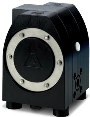
Die Gehäuseteile der E-Serie werden wie gewohnt über versenkte Zuganker miteinander verspannt. Allerdings stützt sich nicht mehr jeder Zuganker punktuell gegen das Gehäuse ab, sondern über einen Ring erfolgt auf jeder Seite eine gemeinsame Verpressung aller Zuganker. Ergebnis ist eine gleichmäßigere Verteilung der Vorspannkraft und ein höheres zulässiges Anzugsmoment – letztlich eine höhere Pumpensicherheit.
