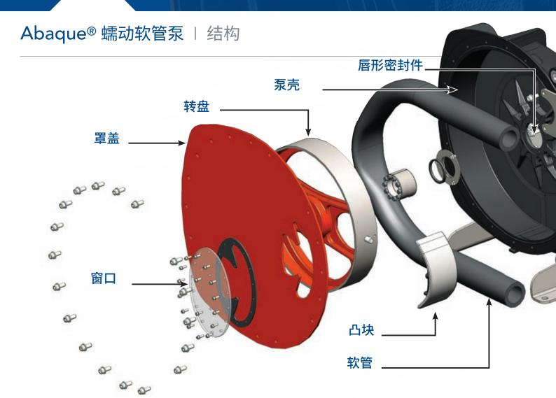
泵壳: 球墨铸铁 法兰和支架: 不锈钢 - ANSI或DIN
